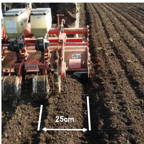
畝立て同時播種作業 (簡易溝切り板)
