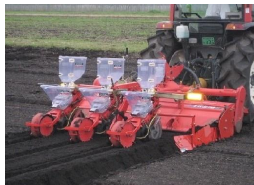
写真2 麦の畝立て同時播種を応用した事例 (畝盛板を装着)
