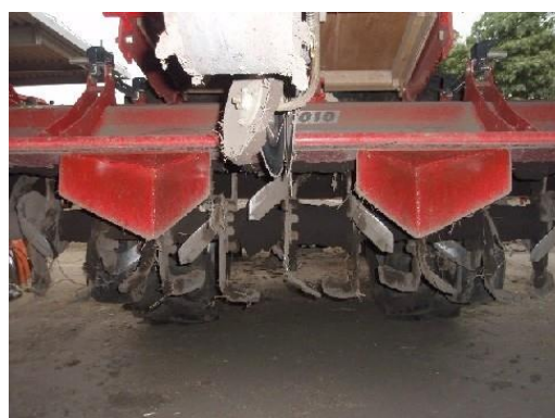
写真4 ロータリに溝切り板を装着した事例
