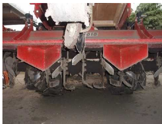
写真4 ロータリに溝切り板を装着した事例
