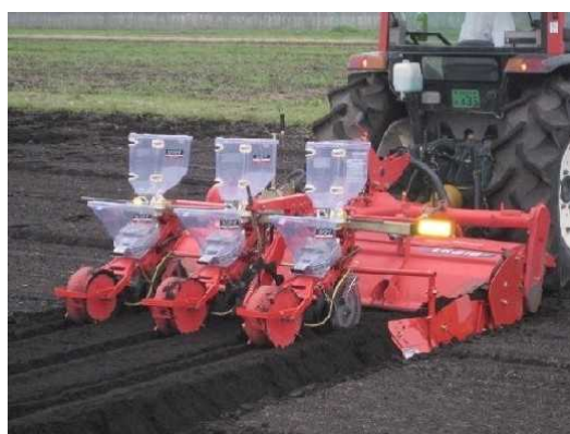
写真2 麦の畝立て同時播種を応用した事例 (畝盛板を装着)
